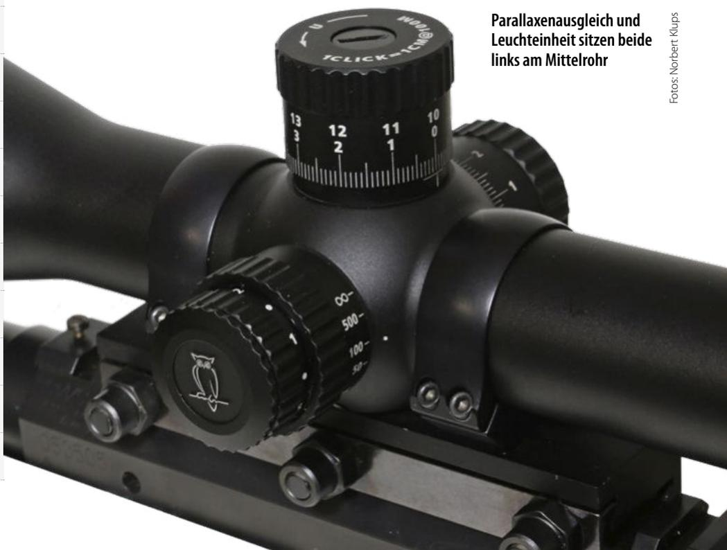
Parallaxenausgleich und Leuchteinheit sitzen beide links am Mittelrohr
